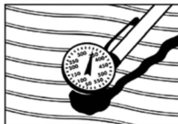
**7** Utilice un termómetro calibrado para verificar punto de ajuste
